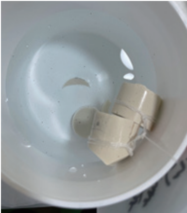
<그림 6> 모의 방사성 농축폐액 분말을 40 wt% 포함한 지오폴리머 고화체의 침수 시험 중 열화 모습
