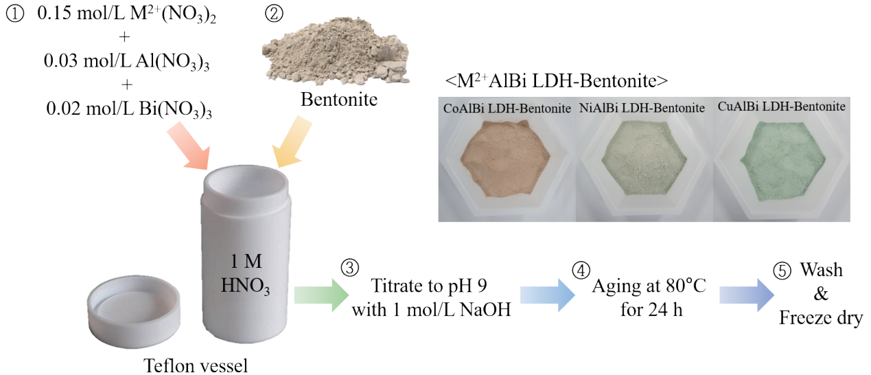
<그림 1> M 2+ AlBi LDH-Bentonite 합성방법 개략도
